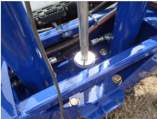
コーン振れ止め(半割、取り外し可)
