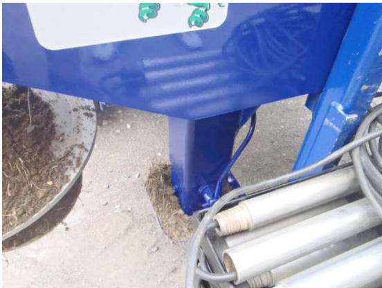
マストの高さ調整(マスト真下)
