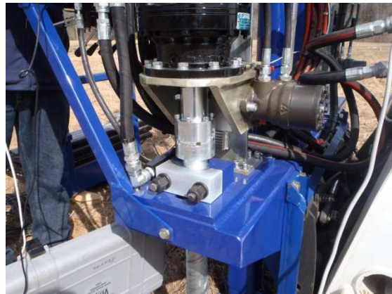
アンカーシステムの固定(ボルト)
