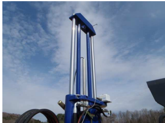
深度計の設置(専用台座、ワイヤ取付金具付)
