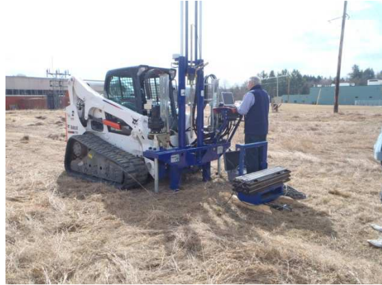
CPT 貫入状況
