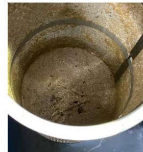
写真1 ストレーナ内ケーキ層 (土砂状)
