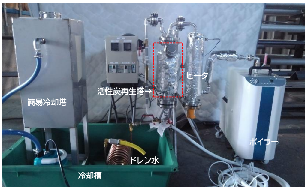
写真-1 卓上型活性炭再生装置の概要
