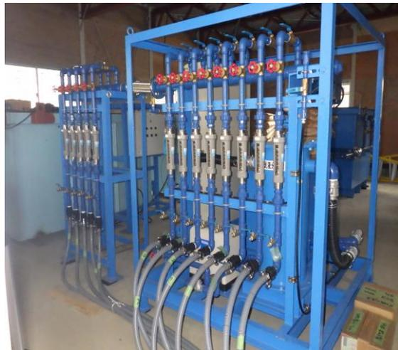
(写真) 土壤ガス吸引装置
