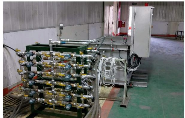
写真-1 負圧吸引型の揚水装置
