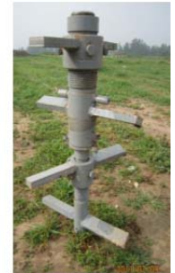
写真-3 深層混合双方向攪拌機のヘッド部分
