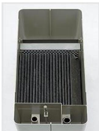
粗粒化フィルターにより、微細油分を粗粒化させ、油分の浮上を促進します。油滴がフィルター内を通過時はランダムに流れるため、粗粒化の効率も高まります。空間率が高いため、スラッジによる閉塞等は最小限に抑えられます。内部の腐食や油の変質などの心配がなく、繰り返し使用が可能です。独自開発された傾斜板ユニットが、粗粒化した油分を効率よく浮上させます。親油性を備えた傾斜板を多数設置することによって、油が板と板の間隙を浮上移動するだけで傾斜板に付着し、非常に効率よく浮上・分離が行なえます。傾斜板そのまま取りはずしが可能で、これも繰り返し使用が可能となっています。
